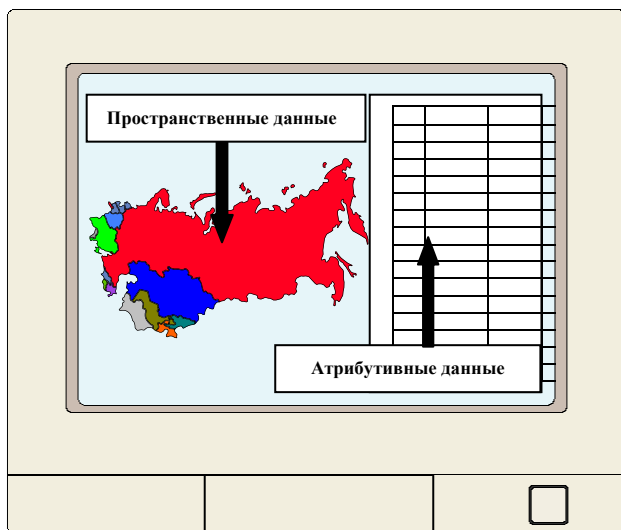
Рис. 1. Система геореляционных баз данных: взаимосвязь пространственных и атрибутивных данных.
